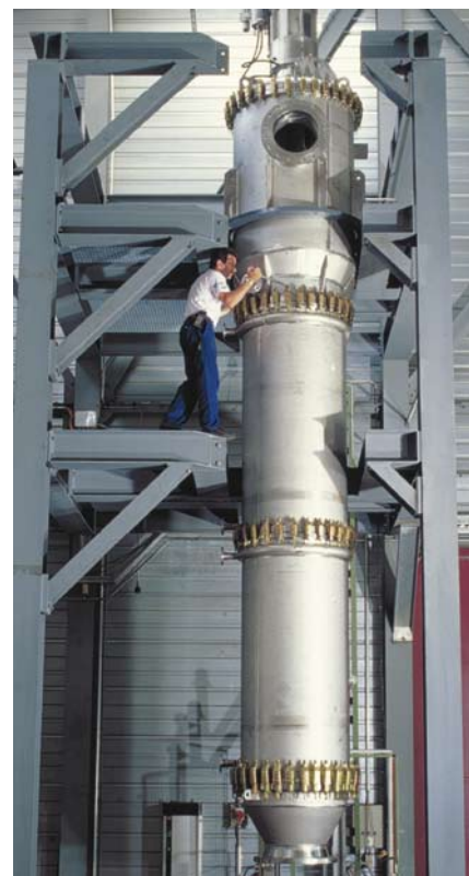
Пленочный испаритель роторного типа для вязких сред
