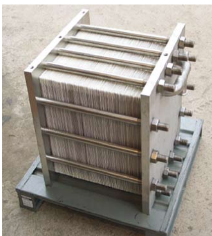
Пластинчатый мембранный модуль для разделения паров. Полимерные мембраны производства компании Зульцер Хемтех
